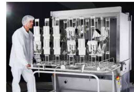
Transportvognen med vægtskålene sikret, rulles vognen til front af JEROS ACE systemet.
